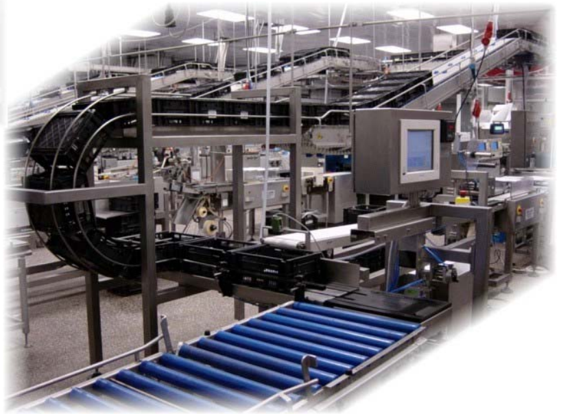
CBL kratten ontstapelen, vullen, kratkaartjes plaatsen en kratten afvoeren.
