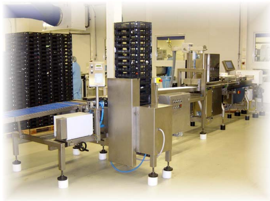
CBL kratten ontstapelen, vullen, kratkaartjes plaatsen en kratten afvoeren.
