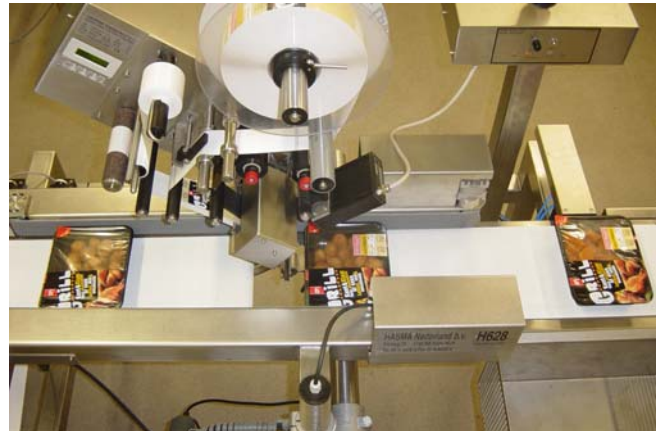
Een etiket aanbrengen op onder-, voor- en bovenzijde van het product, inclusief 100% barcodecontrolesysteem.
