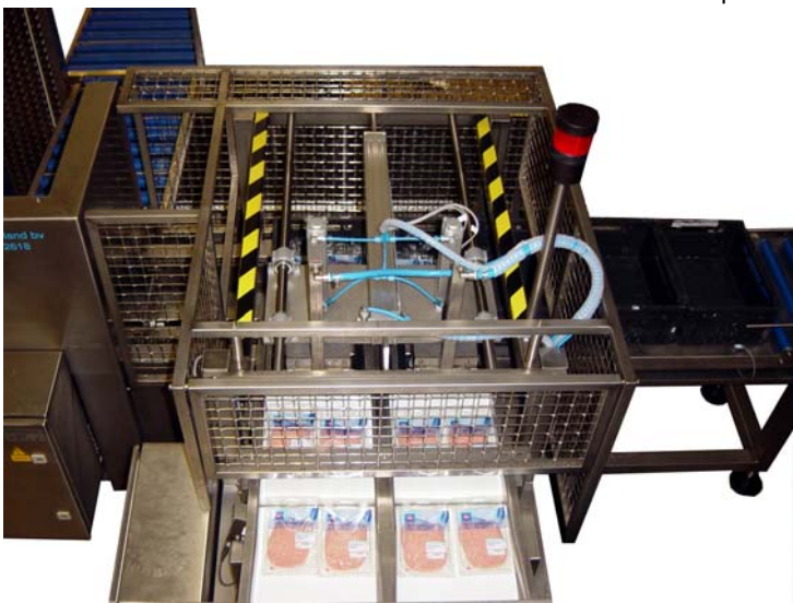
Met een snelheid van 120 stuks/min de verpakte vleeswaren automatisch in een CBL krat plaatsen en de CBL kratten opgestapeld afvoeren.
