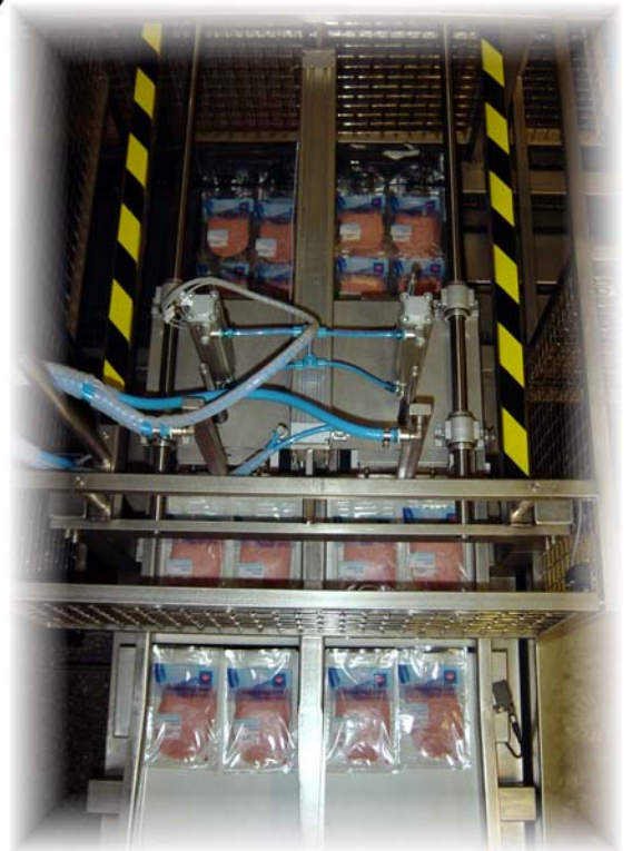
Met een snelheid van 120 stuks/min de verpakte vleeswaren automatisch in een CBL krat plaatsen en de CBL kratten opgestapeld afvoeren.
